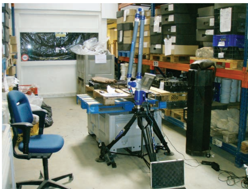
Afb. 7.1 Opstelling van de FARO-meetarm.
